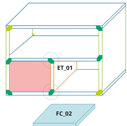
**3.5** Positionner ET-01. Fixer à l'arrière 2 cubix mix pour le maintenir.
